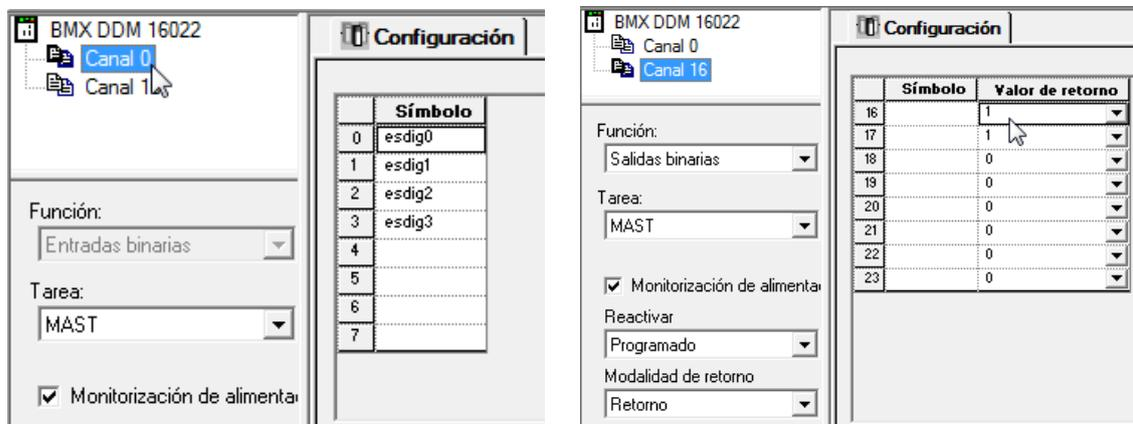
Figura 10. Configuración del E/S digitales.
