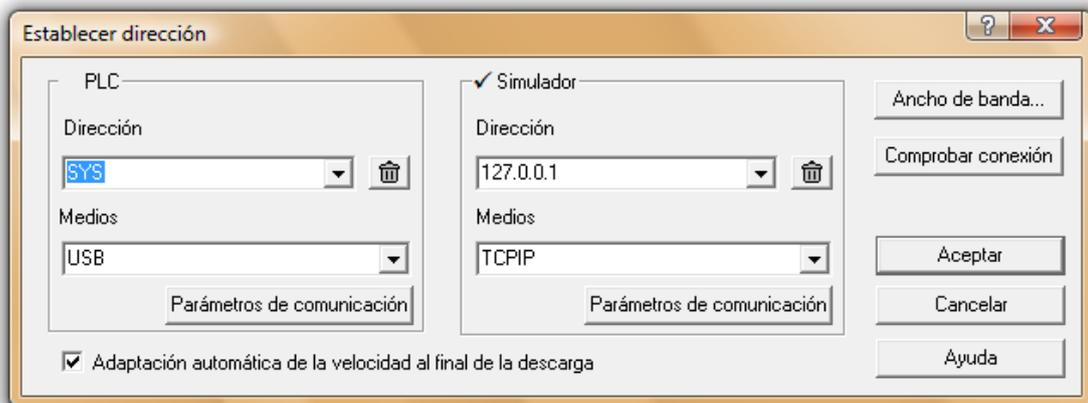
Figura 37. Selección del puerto de conexión al PLC.
