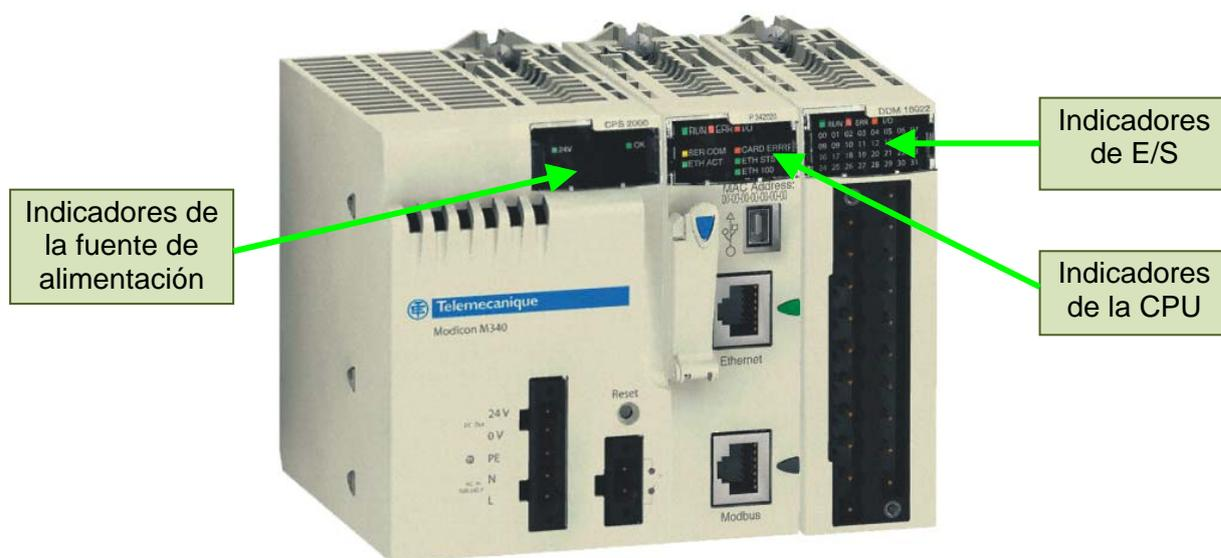
Figura 38. Indicadores de los módulos del PLC.
